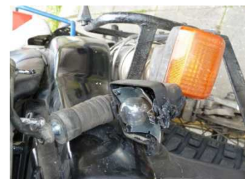
Kleine Reparatur zuhause: Der abgeknickte Blinker wurde vom Abgas zerlegt.
